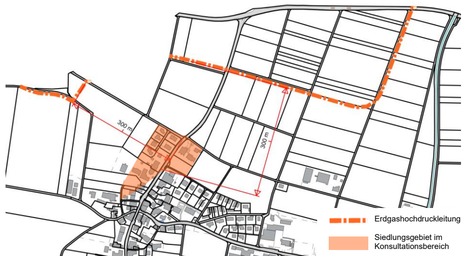
Abbildung 41: Konsultationsbereich der Erdgashochdruckleitung
